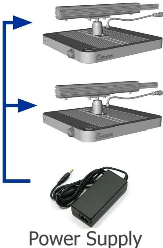
Beispiel für eine Anschlusskonfiguration bei 2 LED-Modulen
